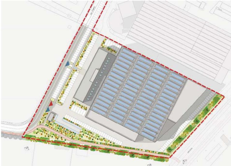
Come riportato nella Relazione tecnica (par.3.2) il nuovo stabilimento svilupperà circa 9.800 mq di nuova superficie industriale mono piano ed ulteriori 3.050 mq di uffici connessi, in una nuova palazzina su tre livelli fuori terra ed uno interrato, fronte via Pompei (fase 1); inoltre il PA contempla una fase 2 prolungata nel tempo per tutta la durata di vigenza della Convenzione Attuativa e rivolta a soddisfare esigenze di ampliamento e modifiche oggi non prevedibili (par.3.1).
